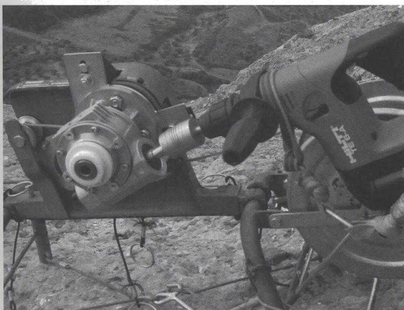
Prueba en la Visera de los Mallos de Riglos. Torno con taladro eléctrico.
